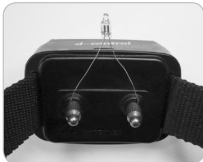
*Fixation de la lampe test sur les électrodes*
