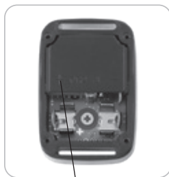
Indication de la polarité de la pile
